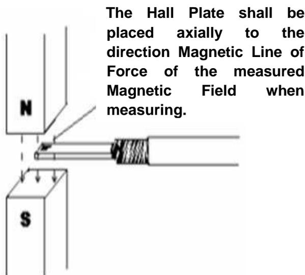
**Fig. 1: Transverse Probe**
